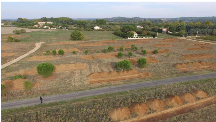
À l'issue de la phase terrain, sauf accord particulier avec le maître d'ouvrage, le remblaiement est effectué sans compactage, dans l'ordre initial des terres en place, en retirant les bois et déchets divers, même si ces derniers étaient présents lors du creusement.
