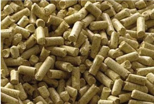
Les **granulés de bois** sont fabriqués avec de la sciure issue de l'industrie du bois : ces sciures sont transformées en granulés par pressage si elles sont sèches. Elles sont préalablement séchées avant compression si elles sont humides. Dans les deux cas, les granulés ne comportent pas d'additifs. Le granulé de bois est un produit beaucoup plus homogène que la plaquette, donc plus facilement utilisable, mais il nécessite plus d'énergie pour sa fabrication.
