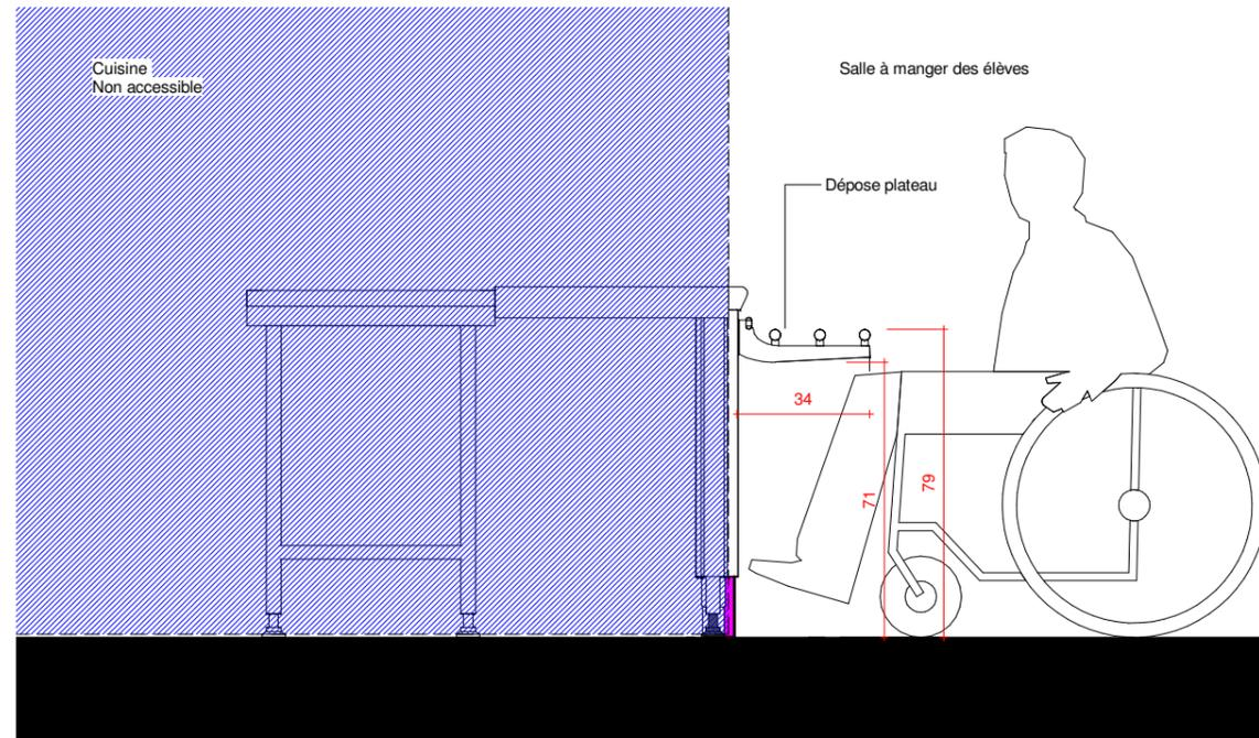
Détail 10 - Coupe de la dépose plateau
