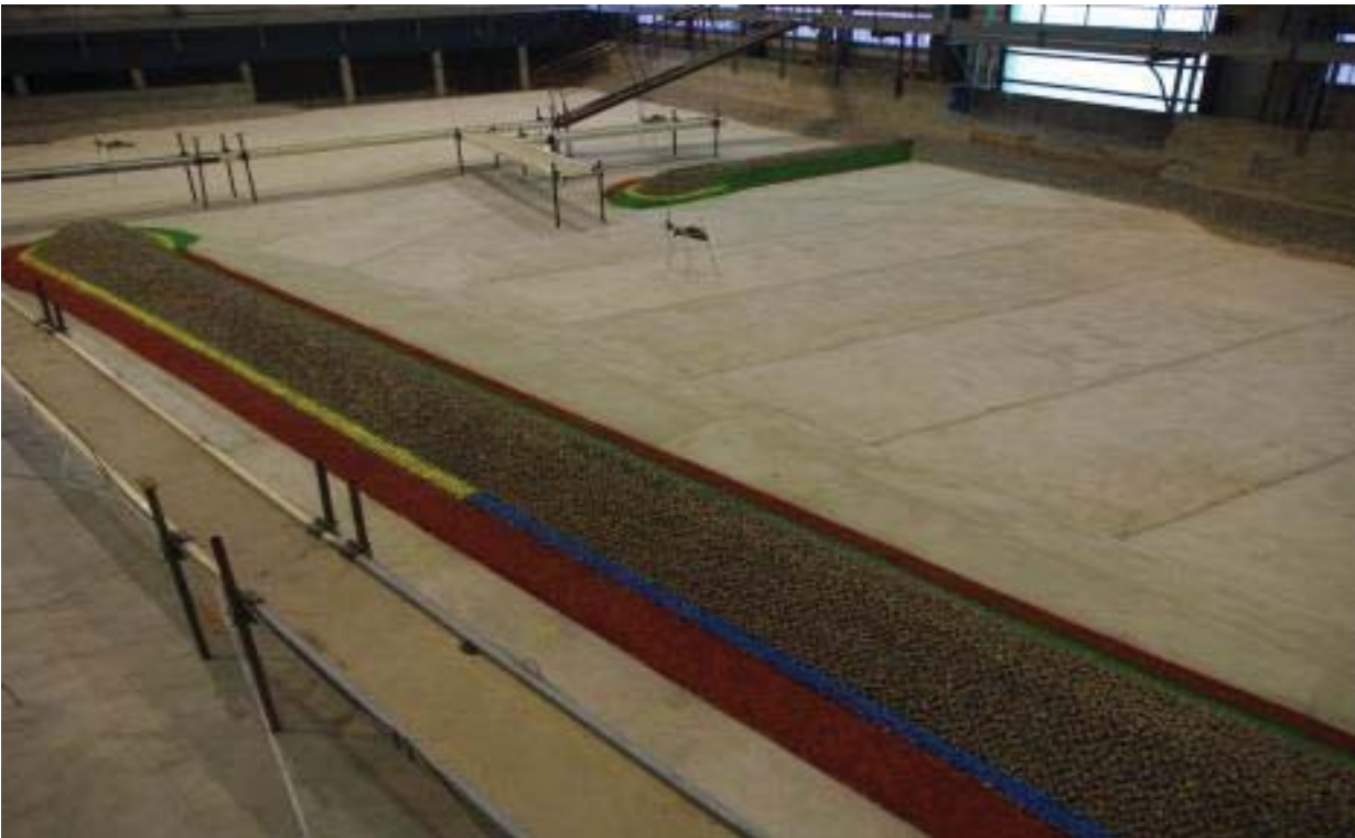
7. L'appareillage de mesure est mis en place, les enrochements sont peints, les passerelles mises en place
