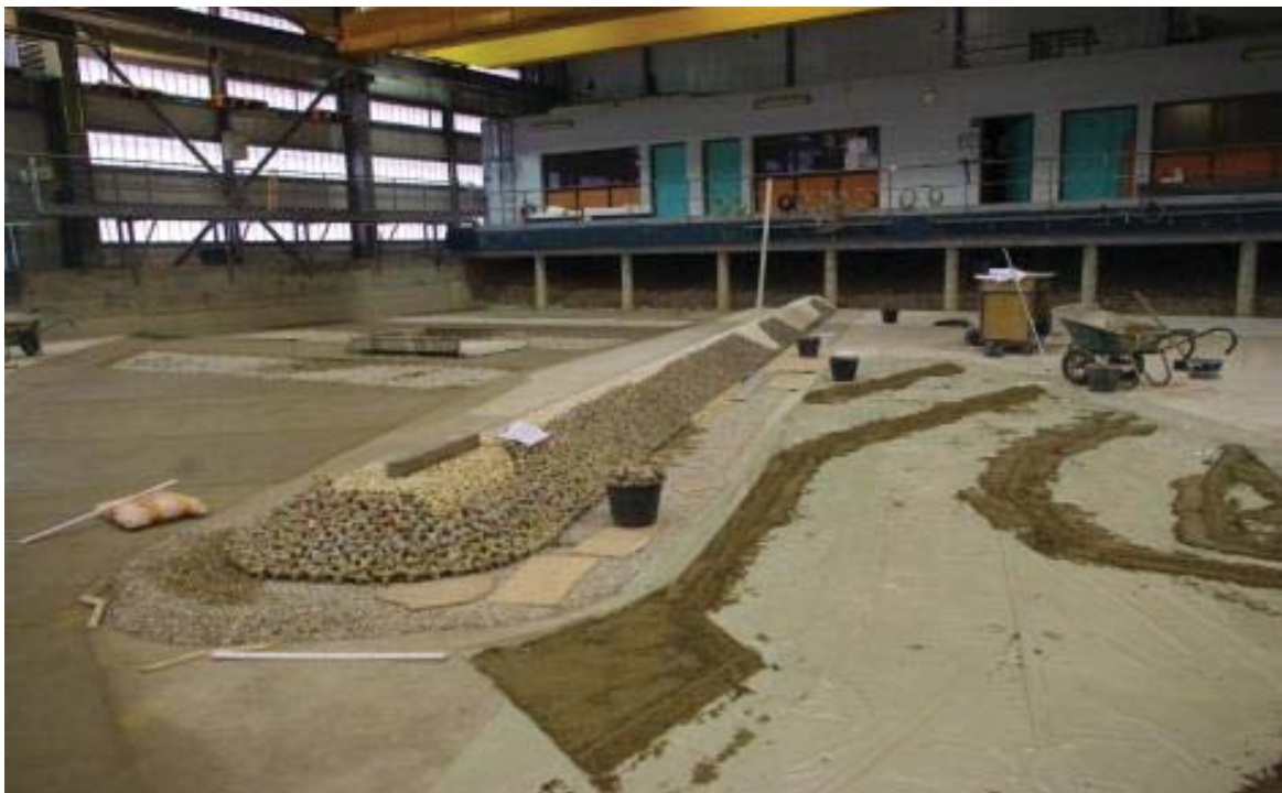
Etape 6: Mise en place des blocs de carapace posés un par un (12 000 unités)
