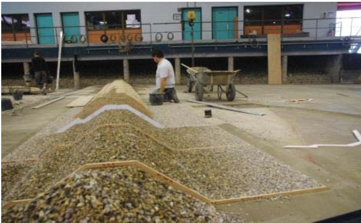
Etape 5: Mise en place de la sous-couche
