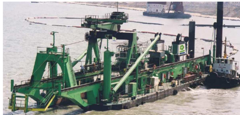
Exemple de drague stationnaire avec conduite de refoulement rechargeant une plage
