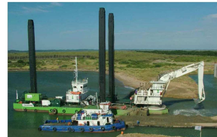
Exemple de drague à pelle mécanique
