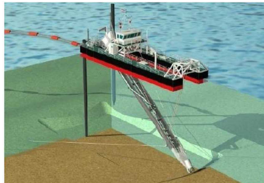
Vue d'artiste d'une drague suceuse à désagrégateur
