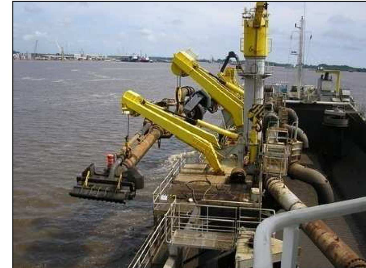
L'élinde avec au bout la crépine, débordée à l'aide des treuils et des bossoirs
