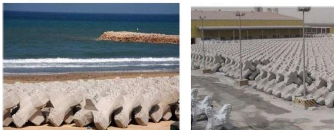
Exemple de zones de stockage d'Accropode II™ en une ou deux couches
