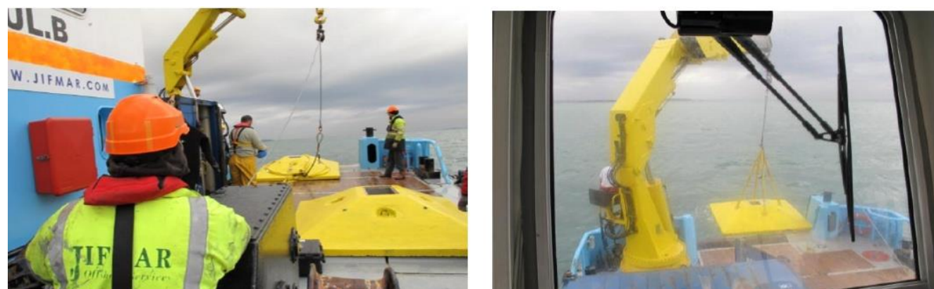
Figure B - 7. Le déploiement des appareils de mesure de la houle et des courants
