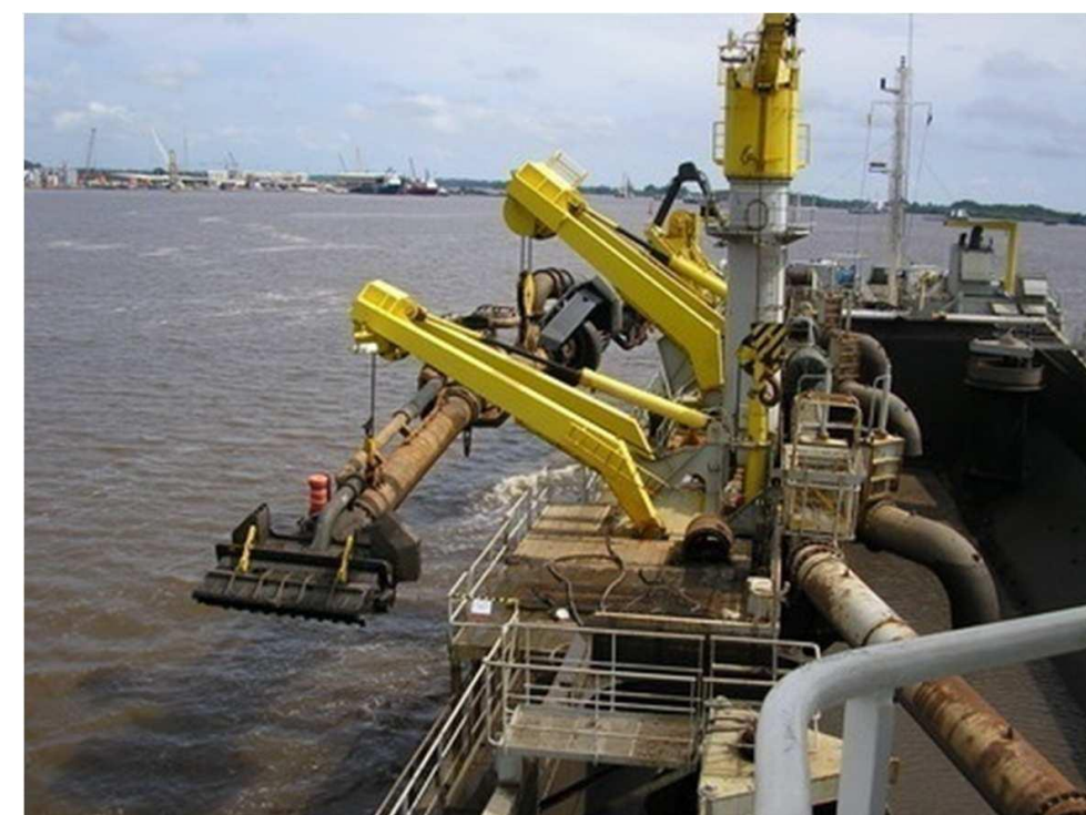
Figure B - 73. L'élinde avec au bout la crépine, débordée à l'aide des treuils et des bossoirs
