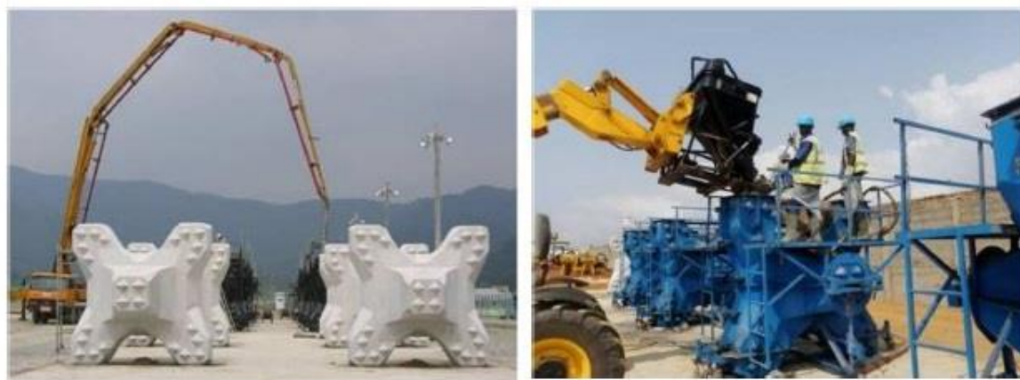
Exemple de zones de fabrication d'Accropode II™
