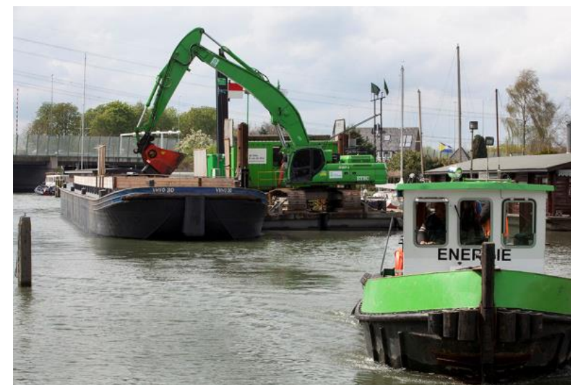
Figure B - 65. Drague mécanique environnementale associée à un chaland
