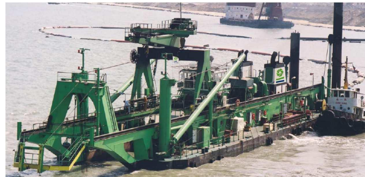
Figure B - 70. Exemple de drague stationnaire avec conduite de refoulement
