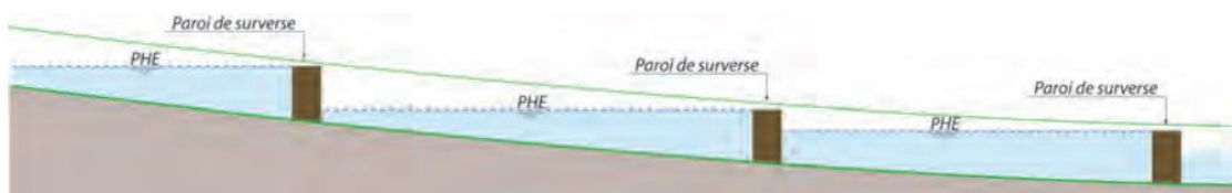
PROFIL EN LONG TYPE D'UNE NOUE SUR TERRAIN À FORTES PENTES
