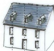
Lucarnes positionnées sur les axes des travées
