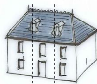
Lucarnes positionnées sur les axes des trumeaux
