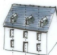
Lucarnes positionnées sur les axes des travées
