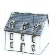
Lucarnes positionnées sur les axes des travées
