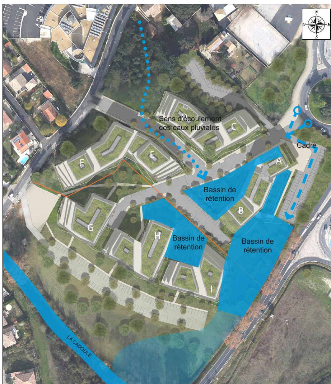
Figure 8 : Principes de gestion hydraulique projetée (source MEDIAE / RELIEF)
