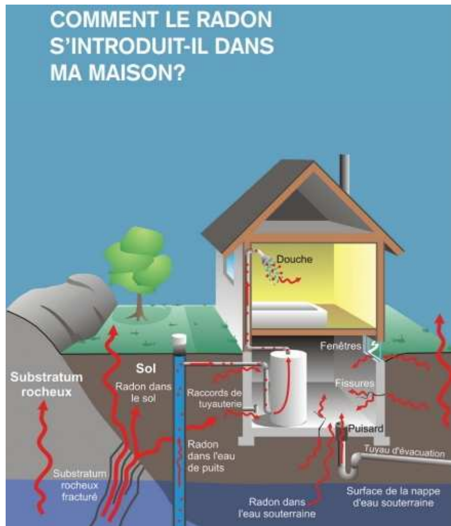
Figure 68 Propagation du Radon dans une habitation - © Santé Canada. Du radon dans votre maison? Janvier 2013
