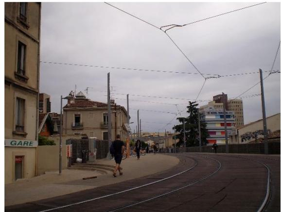
Figure 56: Un ancrage en façade et un poteau
