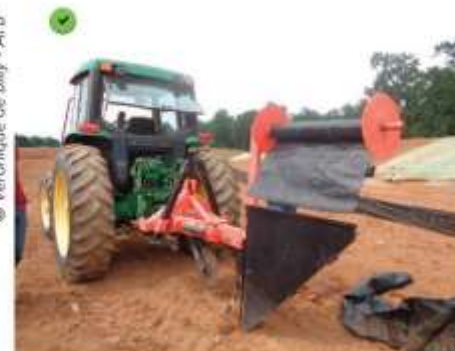
Dispositif d'installation automatique des barrières de rétention.
