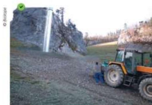
En milieu difficile d'accès, une petite cuve est installée à l'arrière d'un tracteur pour faciliter l'ensemencement.
