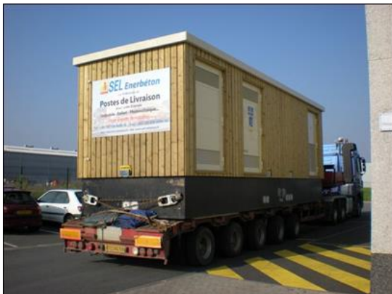
Figure 20 : Transport du poste de livraison (Source : TDA Architecture)
