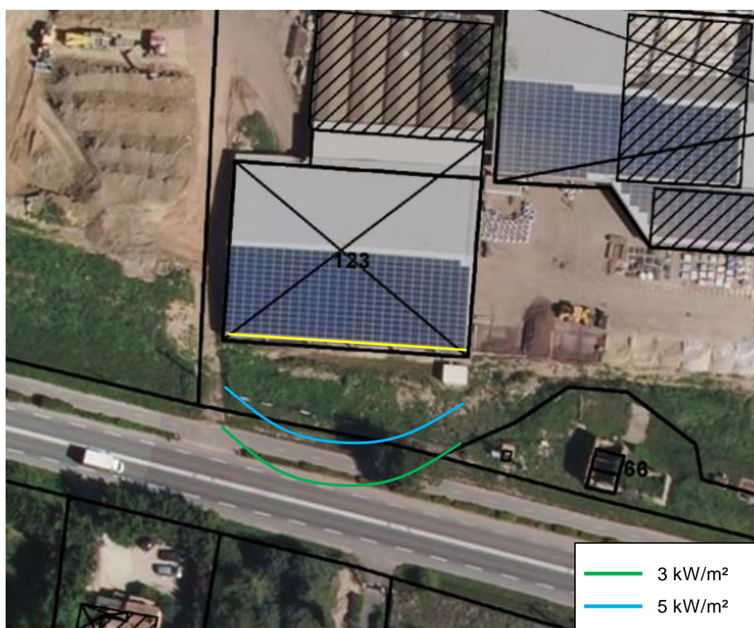
Figure 15 : Représentation des distances des flux thermiques générés à 2 m de hauteur par l'incendie de la zone Z5 en tenant compte de la décroissance du flux aux extrémités du mur de flamme
