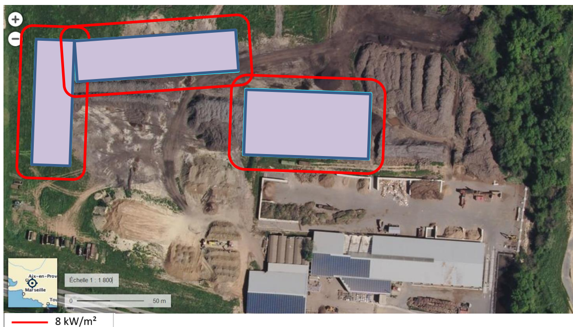
Figure 21 : Représentation des distances attentes par le flux de 8 KW/m 2 en cas d'incendie des stocks de déchets présents sur les terrains de la SCI CHAMAX
