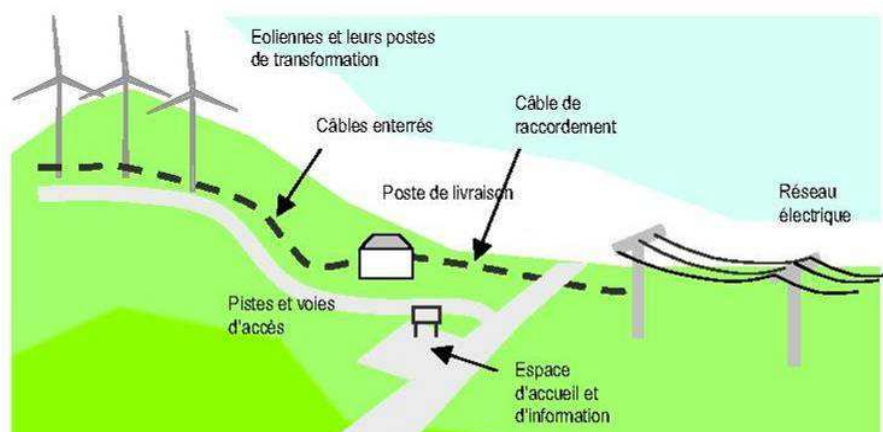
Description générale d'un parc éolien (source SER-FEE)
