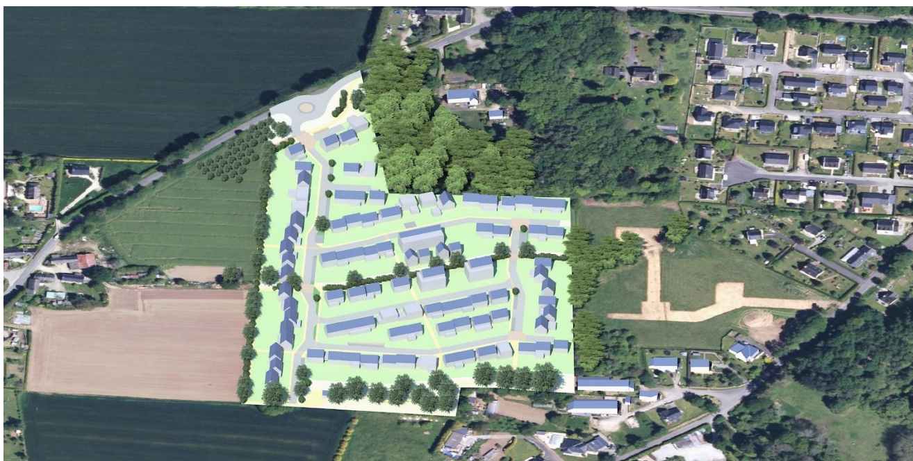
Illustration n°125 : Simulation de l'exposition des toitures à midi, à l'équinoxe, vue depuis le Sud
