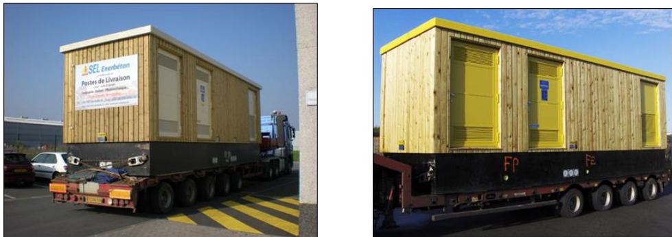
Figure 16 : Transport du poste de livraison (Source : TDA Architecture)
