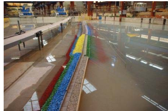
Etape 8: Mise en place des batteurs et des guideaux - Mise en eau du modèle
