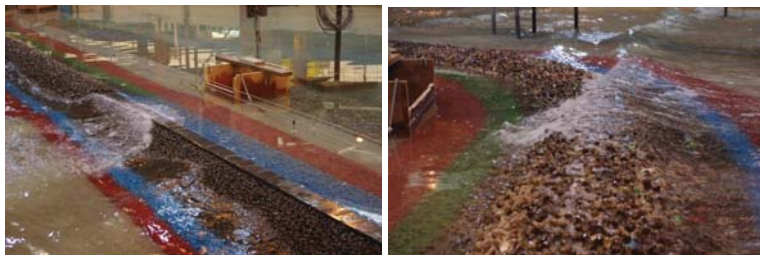
Exemples de franchissements observés pour les conditions de houles « 120% » de la centennale
