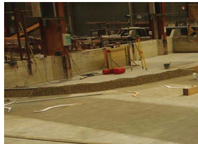
Etape 4: Le noyau de la digue est mis en place
