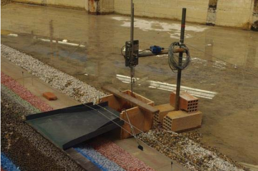
Franchissements à l'extrémité du linéaire équipé de mur de couronnement
