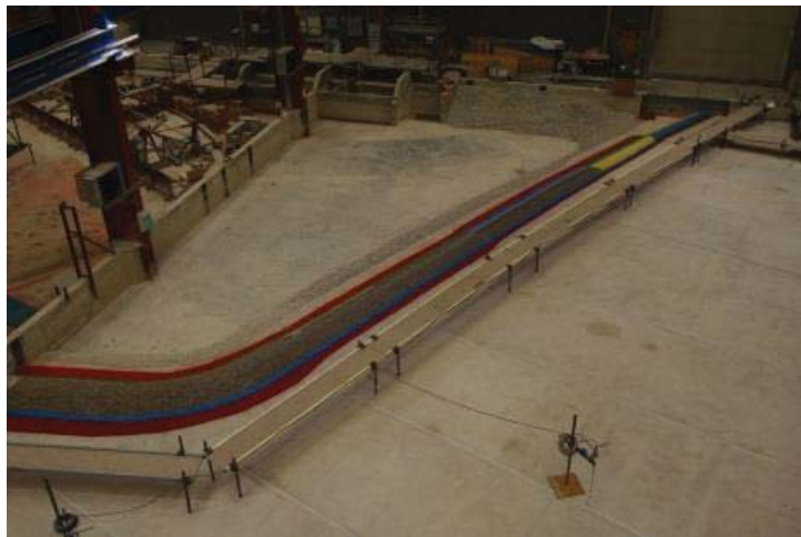
7. L'appareillage de mesure est mis en place, les enrochements sont peints
