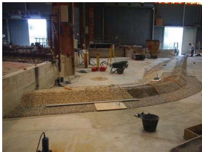
Etape 5: Mise en place de la sous-couche
