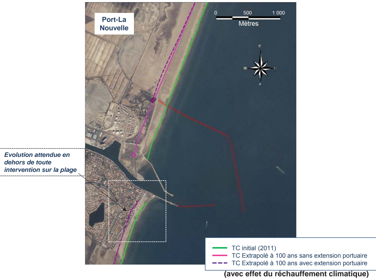
Figure C18 : Position du trait de côte – Extrapolation à l’horizon 2100 avec effet du réchauffement climatique sans et avec l’extension portuaire - Vue de détail sur Port-La Nouvelle
