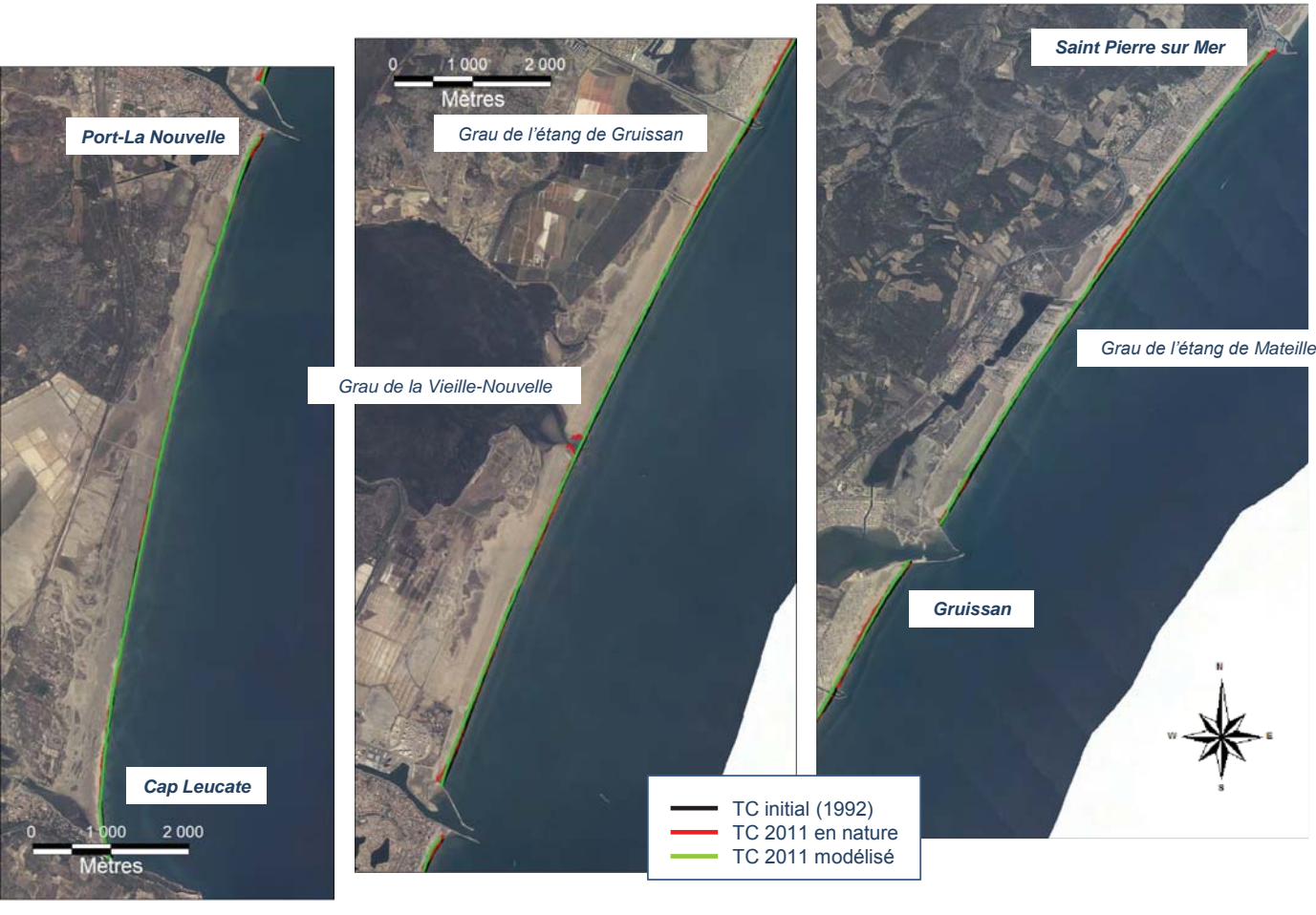
Figure C5 : Période 1992-2011 - Positions du trait de côte initiale et finale en nature et sur le modèle
