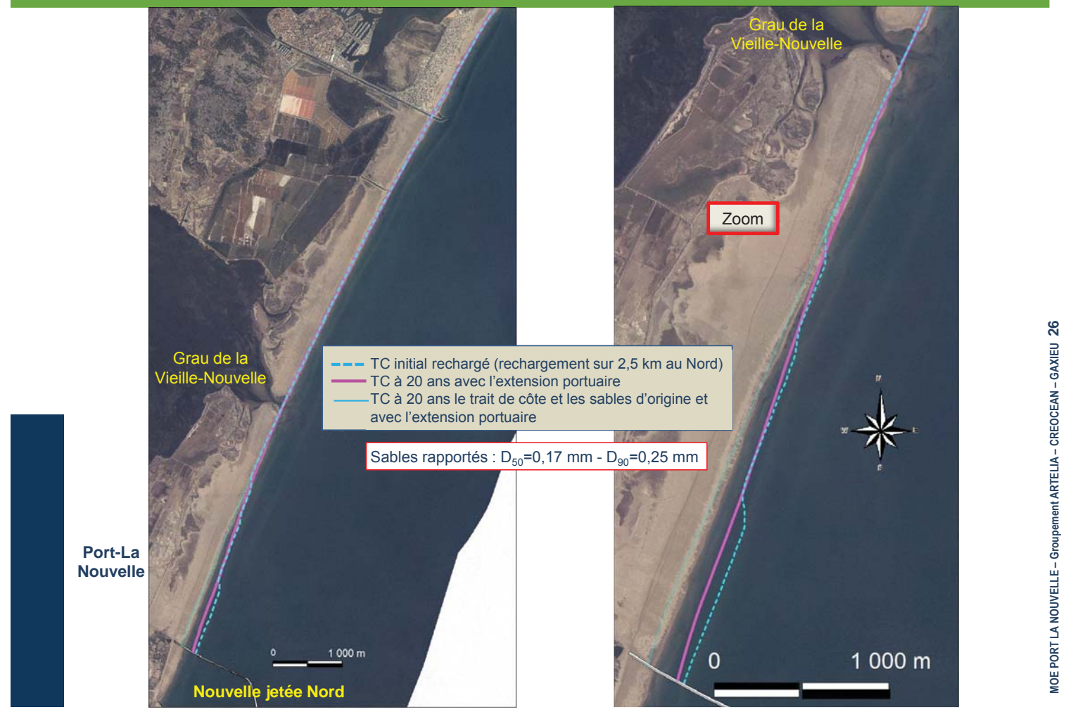
Figure C26 : Scénarios de rechargement - Positions du trait de côte à 20 ans - Impact du projet et devenir du rechargement - Littoral Nord - Calcul 3
