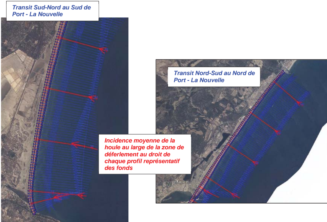
Figure 3 : Modèle Unibest-CL+ - Incidence moyenne de la houle et orientation du transit littoral
