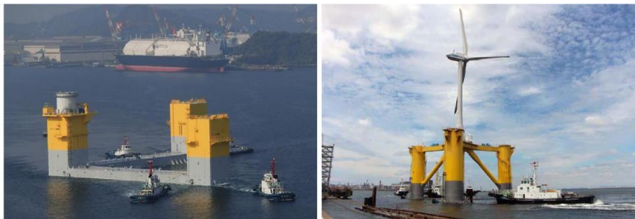
Figure 13 : Exemples de flotteurs acier – Installation au large de Fukushima (Japon)
