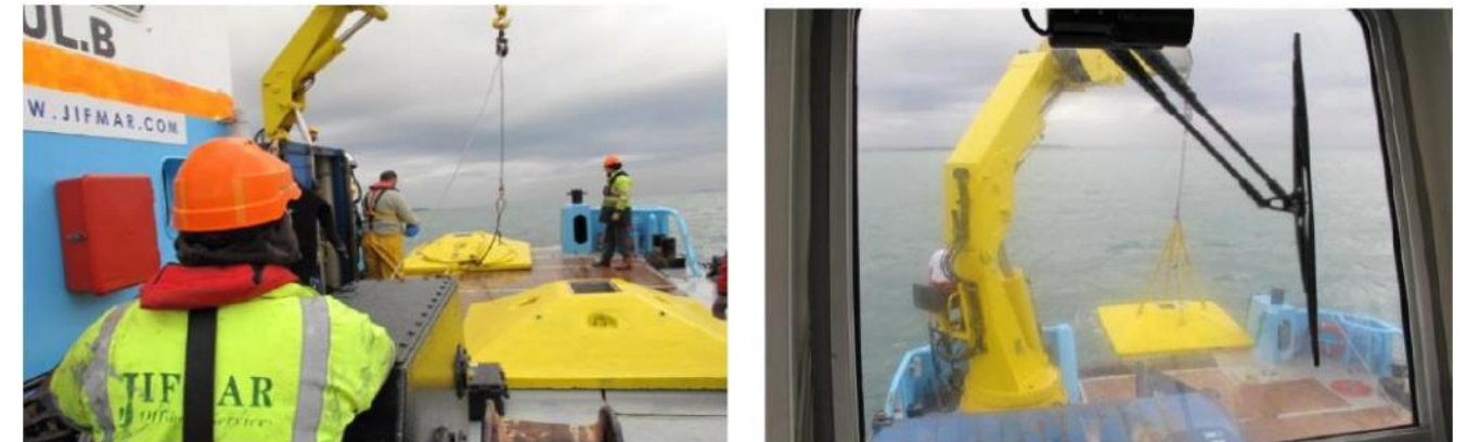
Figure 10 : Le déploiement des appareils de mesure de la houle et des courants
