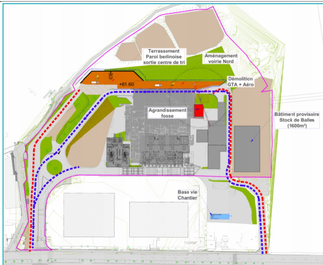
Figure 109. Schéma des flux et base vie pendant les travaux de terrassement de la nouvelle voirie nord
