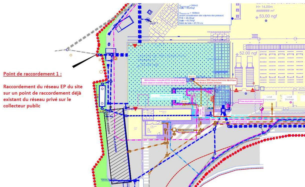
Ci-dessus : extrait du plan de réseau EP projet G-51-SEP-PRO-PS-001-02 faisant apparaître la position d'un des deux points de raccordement déjà existant du réseau EP privé sur le collecteur EP public. Ce point de raccordement est situé à l'extrémité Ouest du site.
