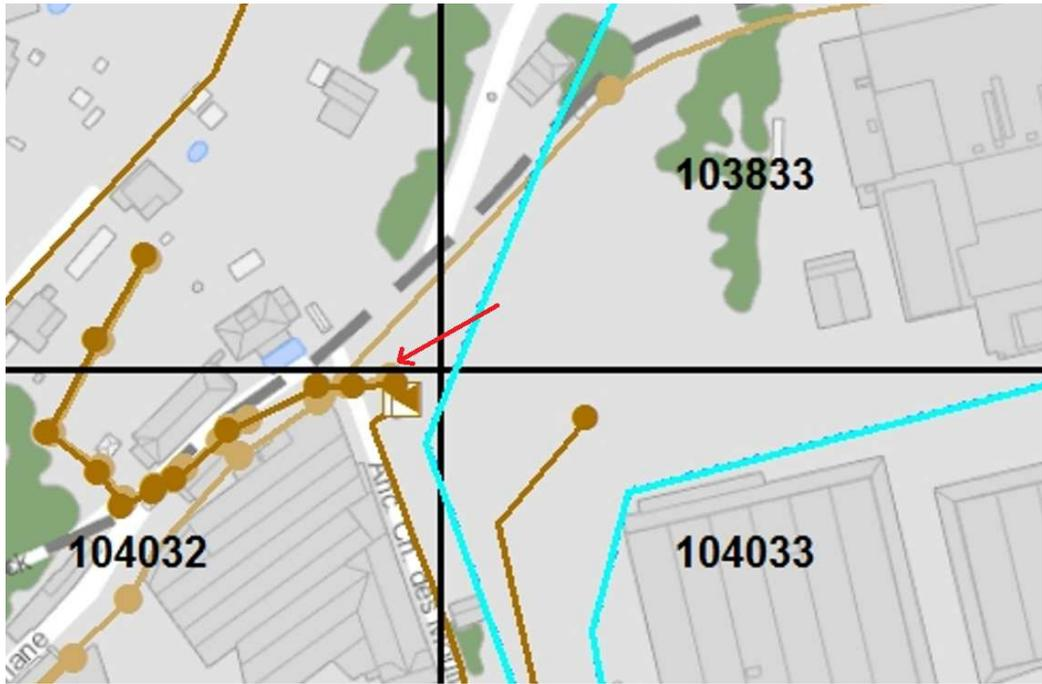
Ci-dessus : extrait d'un plan de réseau EP existant joint au récépissé de DT de MNCA. Le point de raccordement déjà existant du réseau EP privé sur le collecteur EP public est situé à l'extrémité de la flèche rouge.
