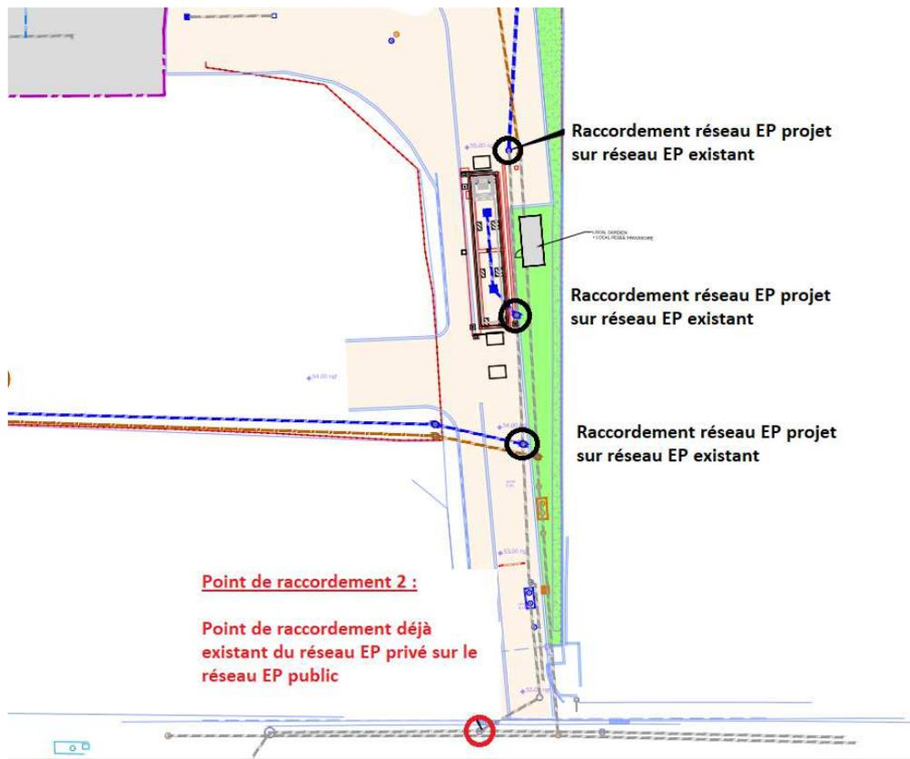
Ci-dessus : extrait du plan de réseau EP projet G-51-SEP-PRO-PS-001-02 faisant apparaître la position d'un des deux points de raccordement déjà existant du réseau EP privé sur le collecteur EP public. Ce point de raccordement est situé au Sud Est du site.
