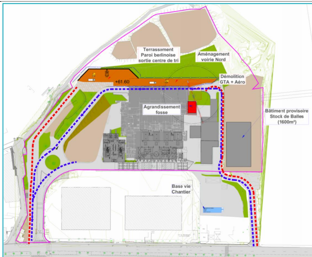
Figure 104. Schéma des flux et base vie pendant les travaux de terrassement de la nouvelle voirie nord
