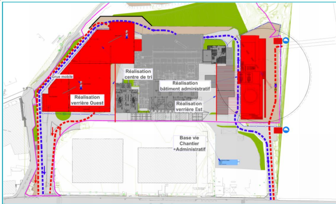
Figure 106. Schéma des flux et base vie pendant la réalisation de la verrière et des bâtiments centre de tri et administratif
