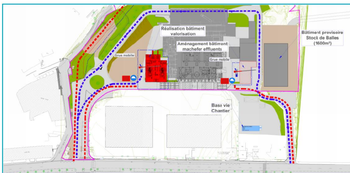
Figure 103. Schéma des flux et base vie pendant les travaux du bâtiment valorisation et des filtres à manches
