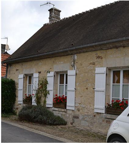
Toiture à 2 pentes à 45° et couverture en petites tuiles plates 75 au m2.
