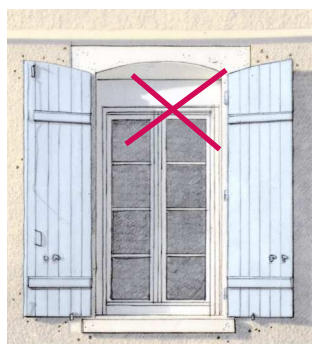
Le volet roulant modifie la proportion de la fenêtre d'origine en réduisant sa hauteur.
