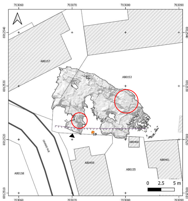
Illustration 34 – Emprise de la cavitité n°19 (ombrage au niveau du toit ; cercles rouges : remontées de fontis)
