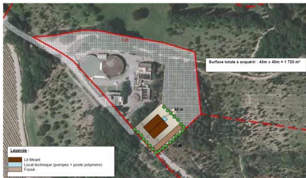
Figure 25 : Implantation projetée des lits filtrants (traitement des boues) sur l'usine de La Môle
