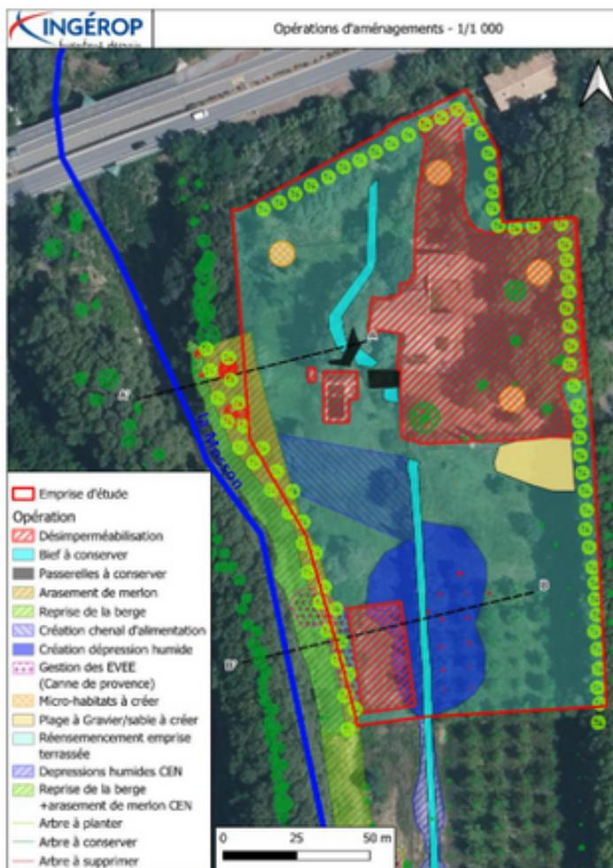
Figure 329 : Localisation des opérations de restauration de la ripisylve par reprise de la berge en rive gauche, arasement de merlon et création de dépression humide dans l'ancien bief de décharge du moulin
